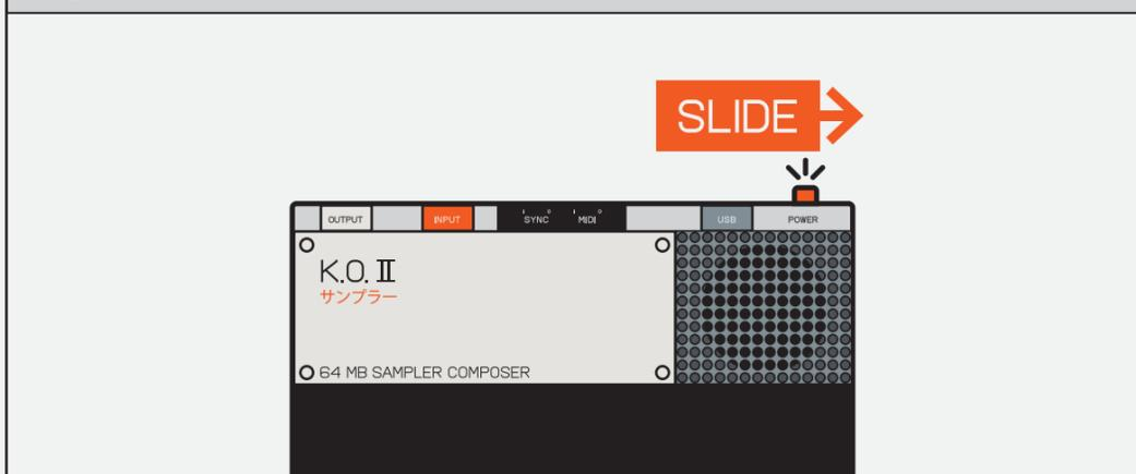
SLIDE THE ORANGE POWER-SWITCH ON THE TOP RIGHT TO POWER ON THE UNIT.
