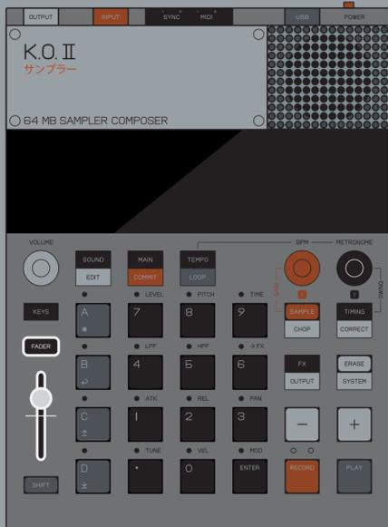
THE FADER ON K.O. II IS A GREAT WAY TO QUICKLY ADJUST VARIOUS PARAMETERS IN A GIVEN GROUP.
