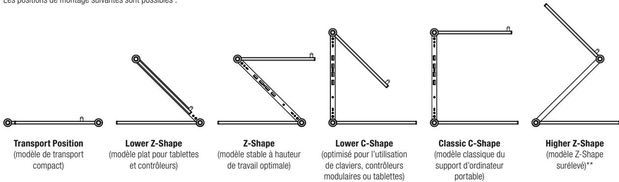
\*\* Pour utiliser le modèle Higher-Z-Shape, vous devez visser les goupilles d'arrêt -4- dans le filetage B -5b-.
