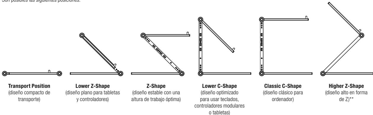
\*\*\* Para usar el diseño Higher-Z-Shape, es necesario enroscar los pasadores de seguridad -4- en la rosca B -5b-.
