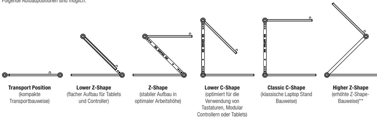
\*\* Um die Higher Z-Shape Bauweise zu nutzen, müssen die Sicherungs-Pins -4- in Gewinde B -5b- geschraubt werden.
